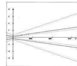
При использовании электродвигателя со встроенным датчиком типа РТ100, сопротивление термодатчика линейно возрастает по мере увеличения температуры обмоток статора электродвигателя начиная со 100 Ом при 0 °C.
