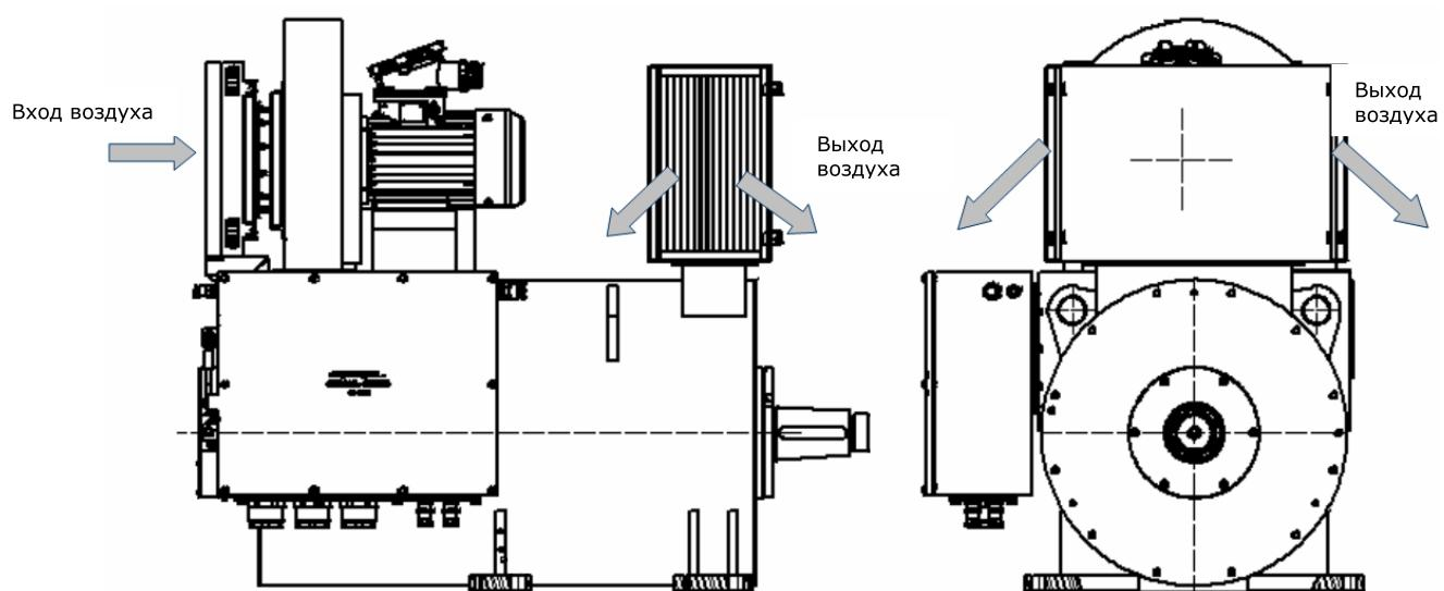
Степень защиты корпуса IP54, Канал входа воздуха IP23 (IP44 - опция), выход воздуха IP24 (IP44 – опция).
