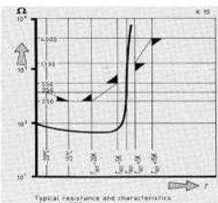
При работе электродвигателя с нагрузкой, не превышающей допустимую по условию нагрева, сопротивление датчика типа РТС не превышает 250 Ом; если нагрузка на электродвигатель становится больше допустимой по условию нагрева, то сопротивление датчика типа РТС резко возрастает до значения более 2кОм.
