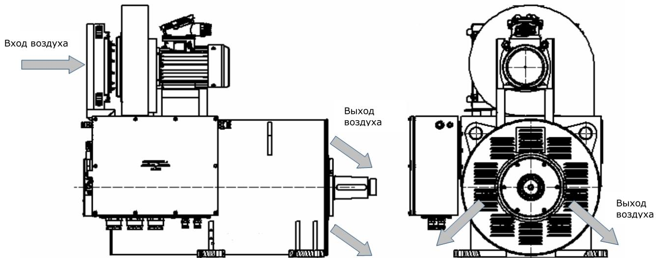
Степень защиты корпуса IP54, Канал входа воздуха IP23 (IP44 - опция), выход воздуха IP23 (IP43 – опция).
