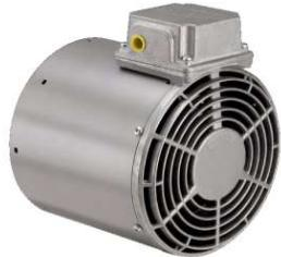
При работе электродвигателя с самовентиляцией (IC411) на низких частотах вращения (менее 50% от номинальной скорости) снижается эффективности собственного вентилятора и ухудшается его охлаждение, как следствие происходит снижение допустимого, по условиям нагрева, тока электродвигателя и нагрузочной способности.
